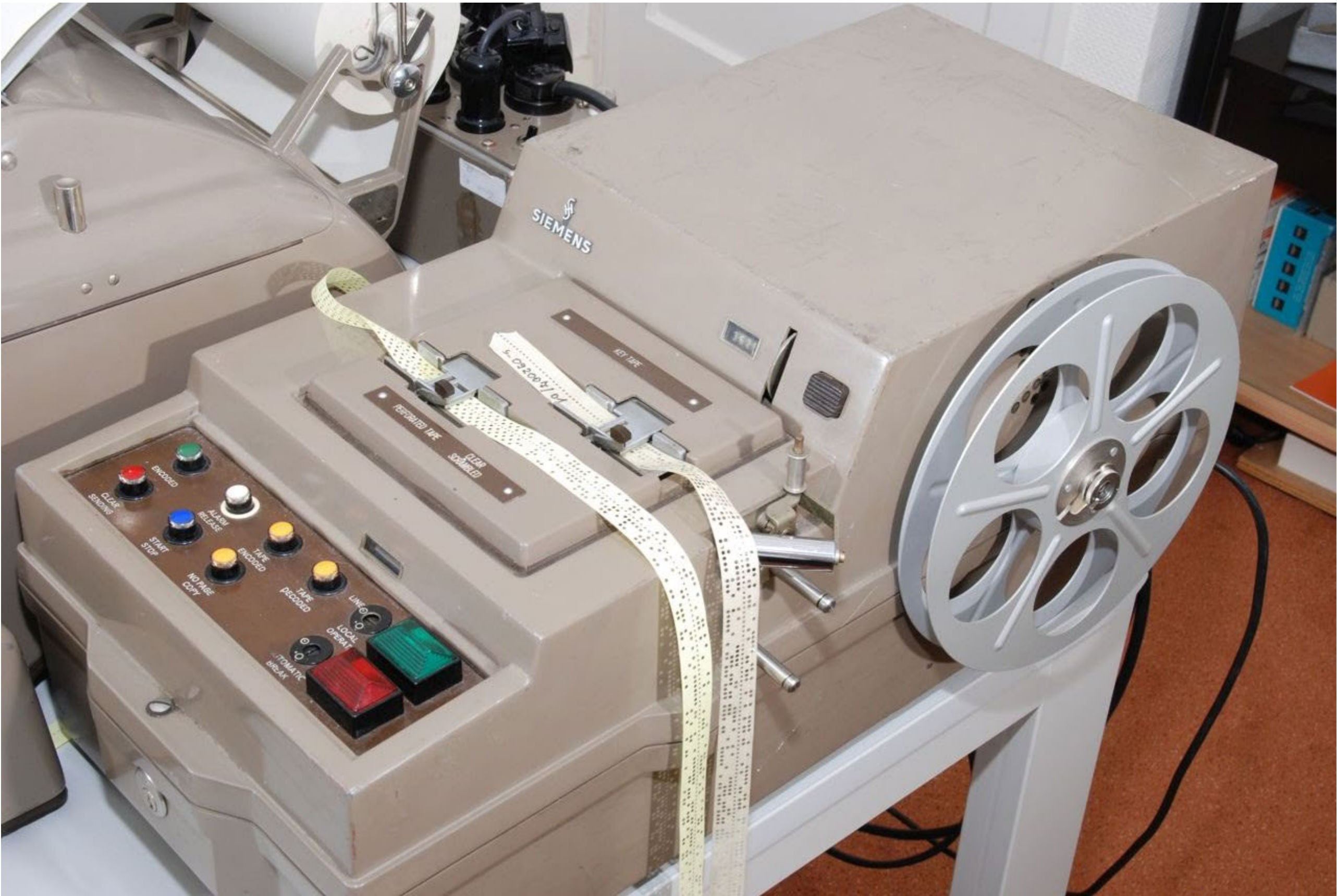
Рис.6.1. Шифровальная машина Siemens M-190 [www.cryptomuseum.com]
