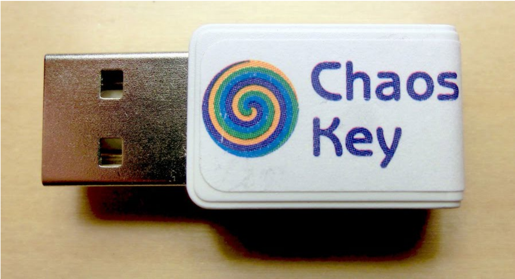
Рис.6.8. Устройство ChaosKey [altusmetrum.org/ChaosKey]
