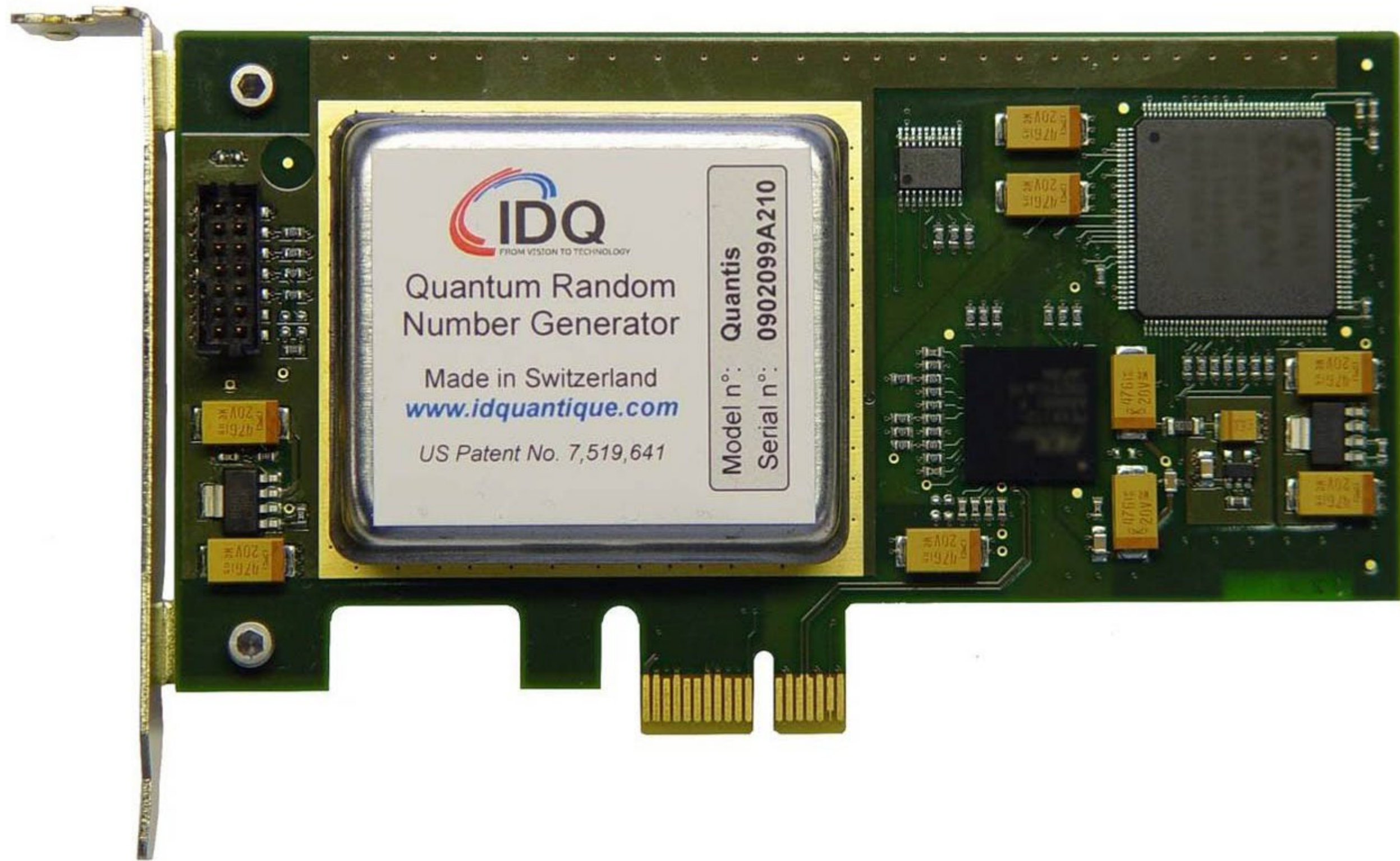
Рис.6.7. Квантовый генератор случайных чисел [www.idquantique.com/random-number-generation/overview]
