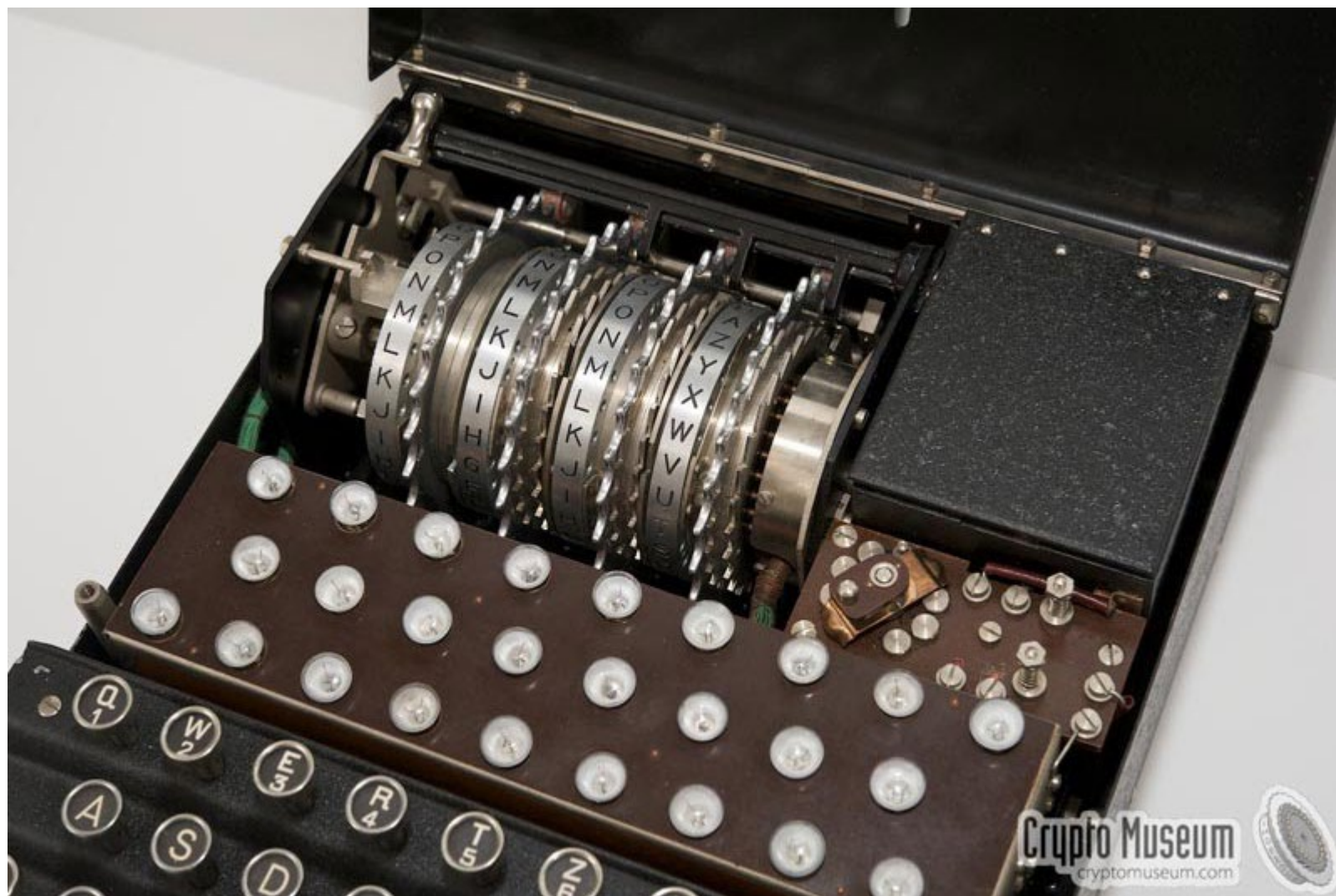
а) четыре последовательно соединённых ротора
