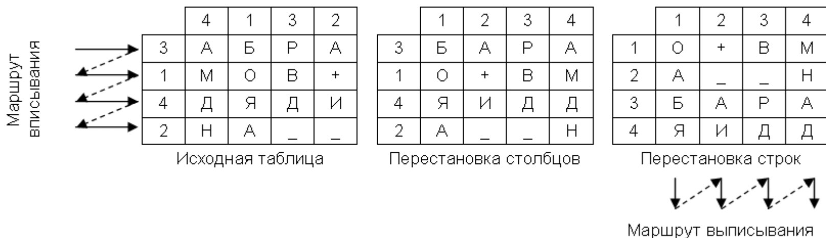
Рис.5.12. Пример использования шифра двойной перестановки
