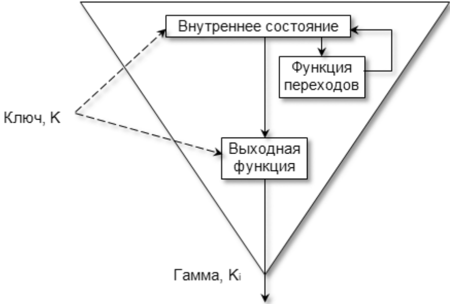
Рис.6.12. Устройство генератора гаммы с внутренней обратной связью
